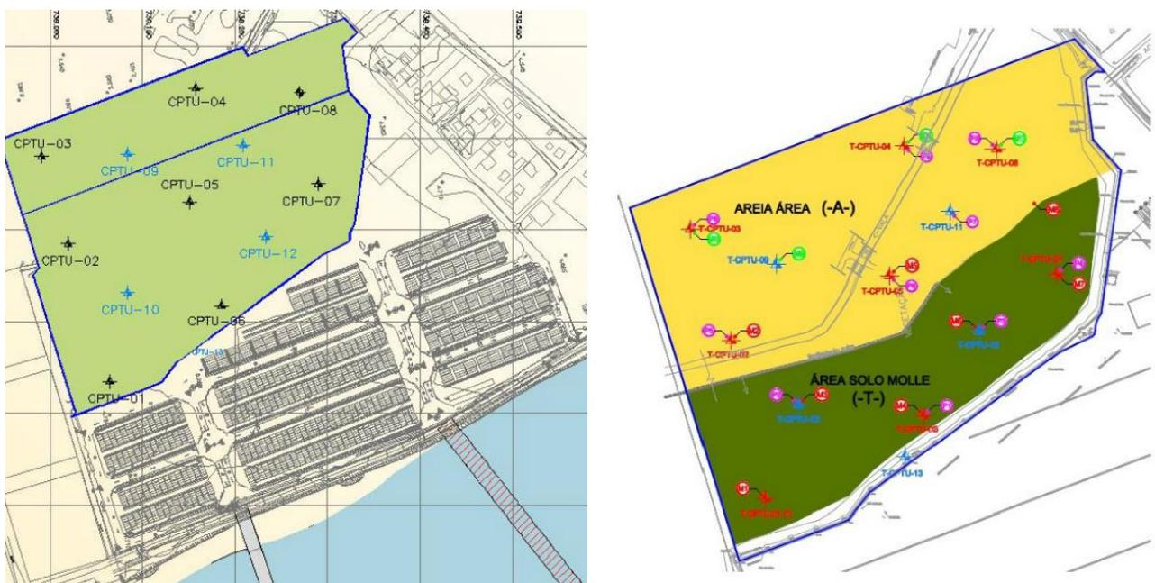
Figura 2 – a) localização dos ensaios CPTU;b) identificação de áreas com solo arenoso e mole aflorantes
