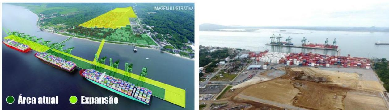
Figura 1 – a) projeto de expansão do Porto de Itapoá; b) vista aérea da área de expansão do porto durante a movimentação do aterro de sobrecarga
